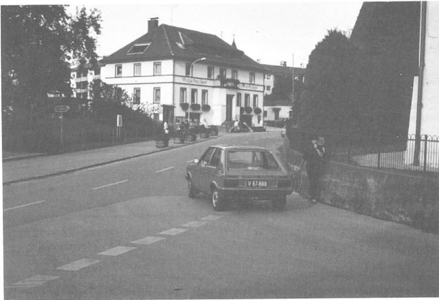
Die Länge des zu errichtenden Gehsteiges beträgt 65 m. Dieses relativ kurze Teilstück wird sehr teuer kommen, da die gesamte Stützmauer zurückversetzt werden muß und mit einer Unterfundamentierung des Hauses Lindauerstraße 67 gerechnet werden muß.
